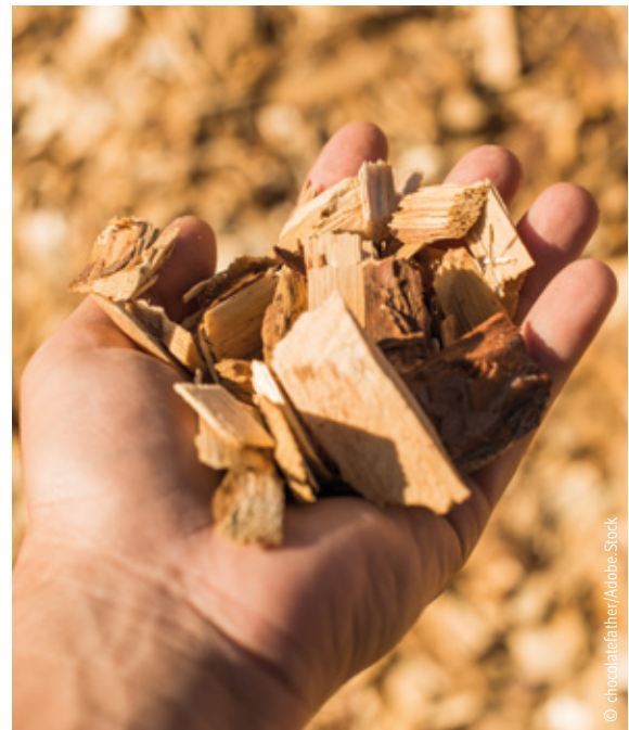
Hackschnitzel zur Herstellung von Faserplatten
