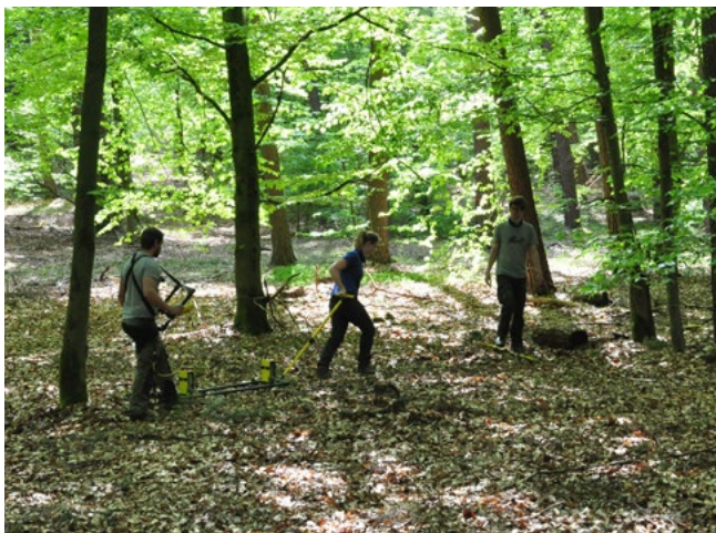
Um die Auswirkungen von Trockenstress auf Waldgebiete sichtbar zu machen, sondieren Mitarbeitende im Projekt den oberflächennahen Untergrund mittels Georadar.
