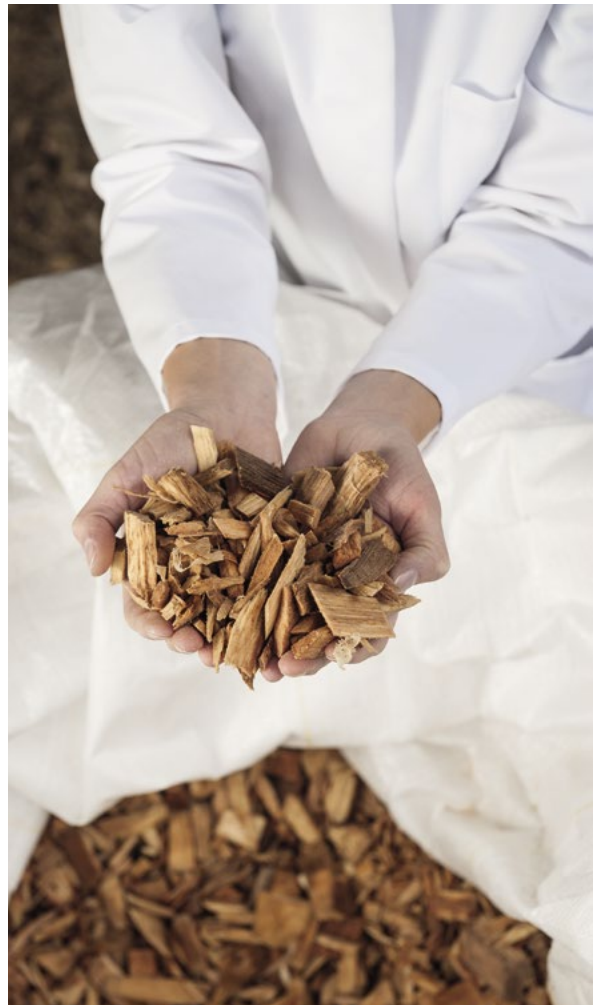
Aus dem zerkleinerten Buchenholz wird hochreines Xylan gewonnen, das als Grundstoff in der pharmazeutischen Industrie eingesetzt werden kann.
